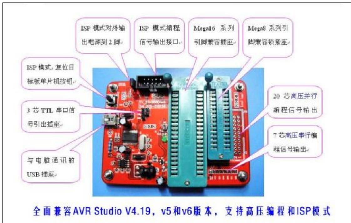
编程器板上的两个锁紧座可以直接烧写与 **Atmega16** 及 **Atmega8** 引脚兼容的芯片，**40** 脚的锁紧座可直接放置如下型号的芯片，
