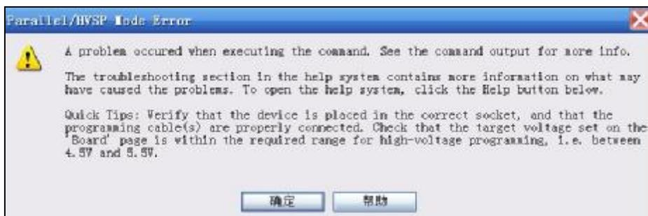
如果遇到出错时，可检查一下芯片是否正确可靠地放置到锁紧座上，再次测试如果故障依旧时可切换到 **main** 选项页执行读取芯片 **Id** 的操作，更能发现问题所在。
