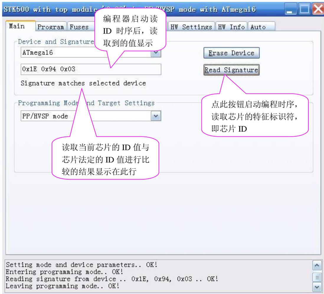
点击上图中的读 ID 按钮后，编程器就会启动编程时序执行读芯 Id 的操作，如果读取到的芯片 ID 与芯片文档中介绍的 ID 相符时，就会在比较结果的位置显示“**Signature matches select device**”此句的意思是“特征符与所选芯片匹配”。如果单击读 ID 的命令按钮后，出现如下图所示的内容“**WARING: Signature does not match selected device!**”，就表明没有正确地读取到 Id 或者读取到的值与芯片默认的值不符，Atmel 芯片第 1 个值恒定为 0x1E。
