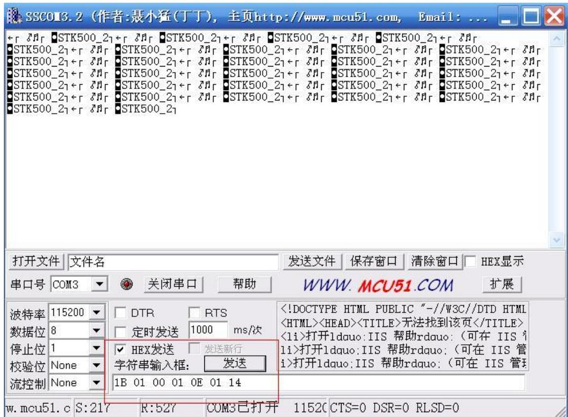
将串口波特率设置为 **115200** 后，打开串口，并用十六进制模式，向串口发送 **1B 01 00 01 0E 01 14** 联机命令包时，编程器会返回带有 **stk500-2** 字样的数据，注意返回用 **ASCII** 码显示。
